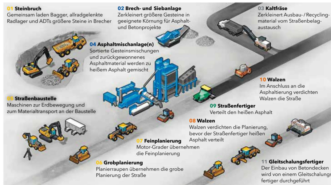
Von der Erdbewegung bis zur fertigen Straße: John Deere und die Wirtgen Group decken den gesamten Produktionsprozess ab.
